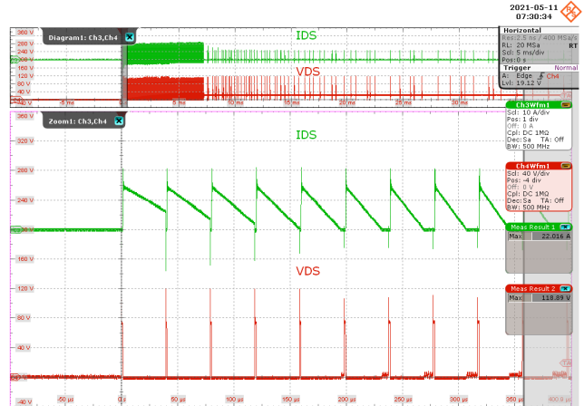
Figure 103 – 440 VAC 60 Hz. CH3: I_{DS} , 10 A / div., 5 ms / div. CH4: V_{DS} , 40 V / div., 5 ms / div. Zoom: 50 \mu s / div. V_{DS(MAX)} = 118.89 V, I_{DS(MAX)} = 22.02 A.
