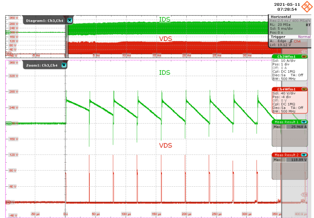
Figure 97 – 440 VAC 60 Hz. CH3: I_{DS} , 10 A / div., 5 ms / div. CH4: V_{DS} , 40 V / div., 5 ms / div. Zoom: 50 \mu s / div. V_{DS(MAX)} = 118.89 V, I_{DS(MAX)} = 25.97 A.
